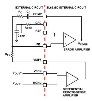
FIGURE 11. OUTPUT VOLTAGE REGULATION LOOP
