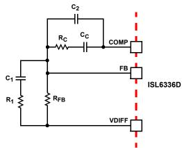
FIGURE 22. COMPENSATION CIRCUIT
