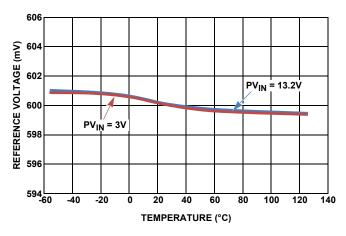
FIGURE 28. REFERENCE VOLTAGE vs TEMPERATURE
