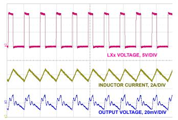
FIGURE 37. STEADY STATE OPERATION 6A LOAD, CCM
