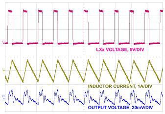
FIGURE 36. STEADY STATE OPERATION NO LOAD, CCM
