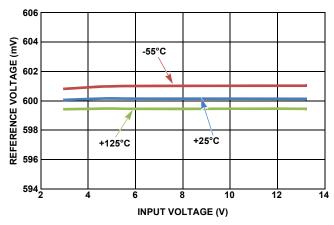
FIGURE 29. REFERENCE VOLTAGE vs VIN
