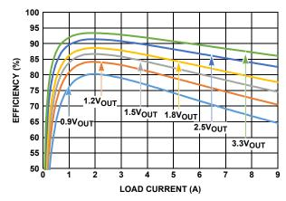
FIGURE 11. EFFICIENCY vs LOAD, VIN = 5V, 500kHz
