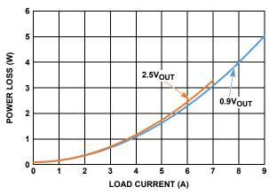
FIGURE 23. POWER LOSS, VIN = 3.3V, 500kHz
