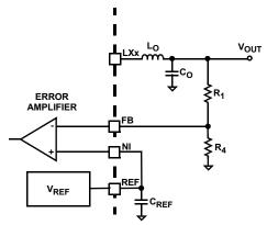
FIGURE 50. OUTPUT VOLTAGE SELECTION
