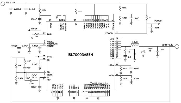
FIGURE 4. ISL70003ASEH SINGLE UNIT OPERATION
