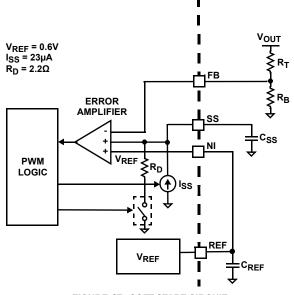
FIGURE 47. SOFT-START CIRCUIT
