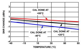
FIGURE 23. SNR PERFORMANCE vs TEMPERATURE
