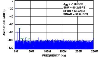
FIGURE 16. SINGLE-TONE SPECTRUM AT 190MHz
