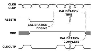
**FIGURE 22. CALIBRATION TIMING**
