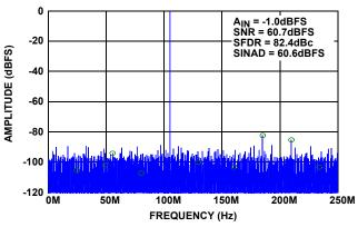
FIGURE 15. SINGLE-TONE SPECTRUM AT 105MHz
