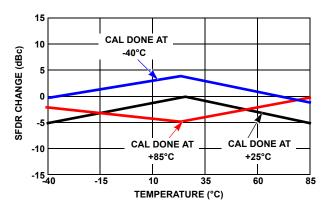
FIGURE 24. SFDR PERFORMANCE vs TEMPERATURE
