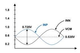
**FIGURE 25. ANALOG INPUT RANGE**
