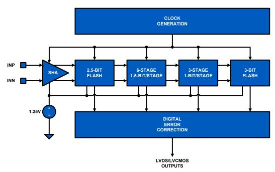
FIGURE 21. ADC CORE BLOCK DIAGRAM
