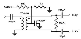
FIGURE 29. RECOMMENDED CLOCK DRIVE
