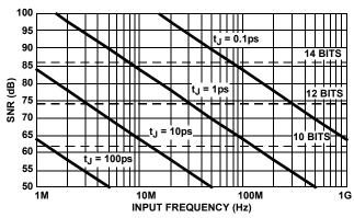
FIGURE 30. SNR vs CLOCK JITTER
