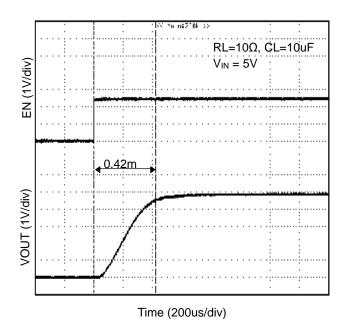
(Λίρ/Λ1) RL=10Ω, CL=10uF: V<sub>IN</sub> = 5V
